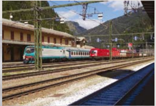
Im Bahnhof Brenner links ein Zug der italienischen FS; rechts rollt mit Schwung und ohne Stromversorgung ein mit 2 Loks bespannter ÖBB-Zug in den Bahnhof ein. Seine Stromabnehmer sind herunter geklappt (abgebügelt); Foto: Gerd Schröter
